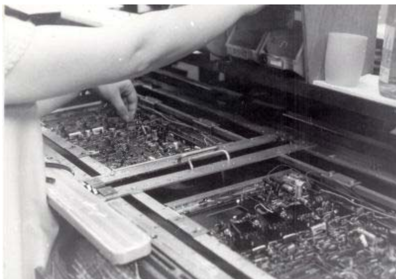
Figure 4a. Mode opératoire « théorique » au poste d'insertion sur la chaîne de montage électronique: mouvements en alternance (d'après Laville, Teiger, Duraffourg, 1972)
