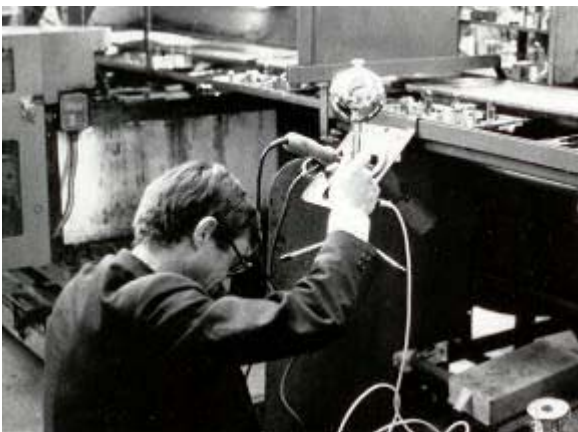
Figure 2a. Réglage des appareils d'enregistrement dans l'atelier de montage électronique sur chaîne (mise au point de la distance œil-tâche par Antoine Laville, d'après Laville, Teiger, Duraffourg, 1972)
